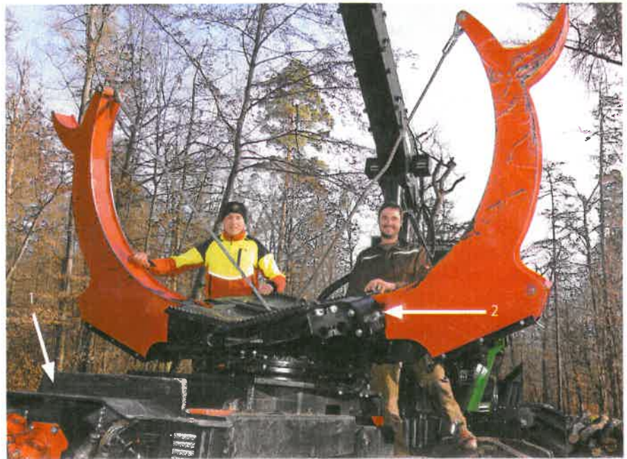
Thomas (rechts) und Manuel Rasch zeigen die Ausmaße der Klemmbank. Die Seilrollen bekamen einen zusätzlichen Schutz (1) gegen herabfallendes Holz; die Seilspannvorrichtung der Klemmbank wurde ebenfalls mit einer Extra-Abdeckung (2) versehen. Fotos: Biernath
