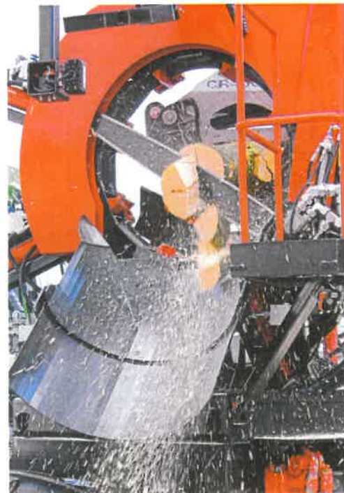
Die Hultdins Supercut trennt die gespaltenen Holzscheite ab
