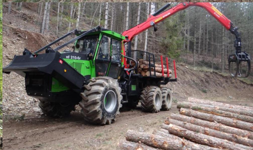
**NF210-6R - ob als Kombinationsmaschine, als Klemmbankmaschine oder als Rückezug, der NF210-6R bringt immer volle Leistung. Im Standard bereits komplett ausgerüstet, bietet die umfangreiche Optionsliste jedem Unternehmer die Möglichkeit die Maschine zu individualisieren..**
