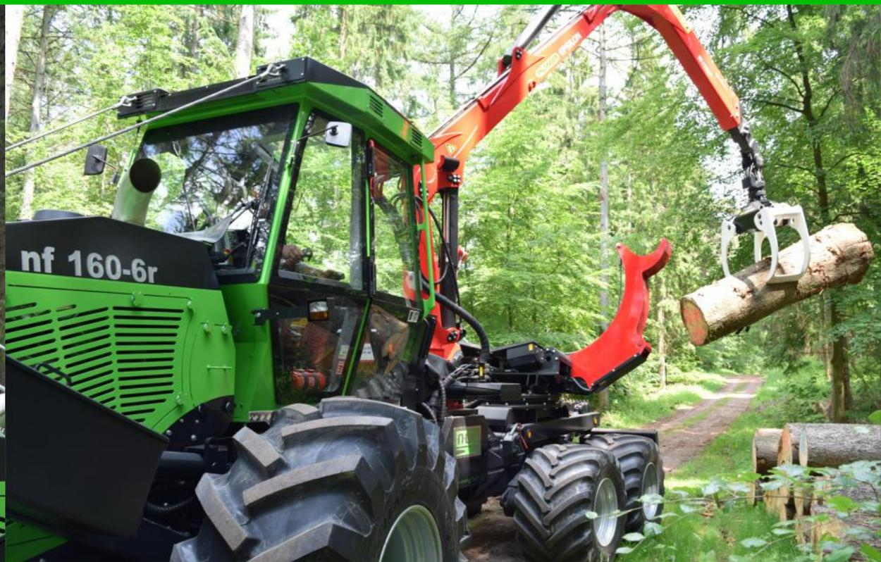
**NF160-6R - 8 to. Nutzlast, eine Klemmbank mit bis zu 1.75 m<sup>2</sup>, ein Rungenkorb mit bis zu 18 m<sup>3</sup> Ladevolumen. Schnell, wendig, kombiniert, kraftvoll**
