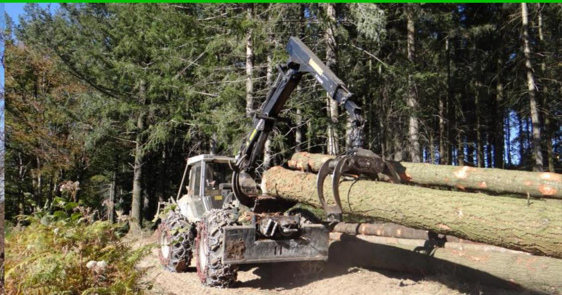
*NF210-4R - 19.1 to. Zugleistung, 1.3 m<sup>2</sup> große Klemmbank auf der Hinterachse. Massive Leistungen eines starken Skidders. Auf Wunsch auch mit Rungenkorb*
